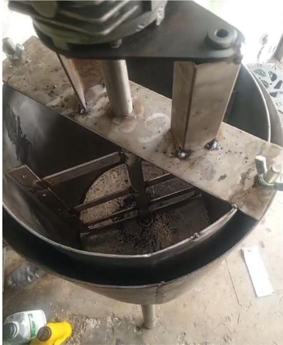
Figura 37. Acoplamiento de Brida, Base del Motor con Eje, **Fuente:** Autores.
