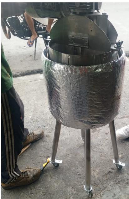
Figura 39. Máquina Mezcladora con Aislamiento Térmico, **Fuente:** Autores.
