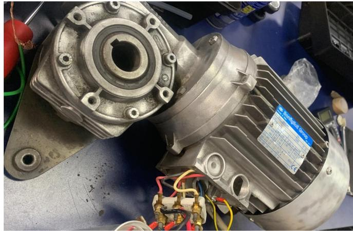
Figura 32. Motorreductor trifásico, **Fuente:** Autores.
