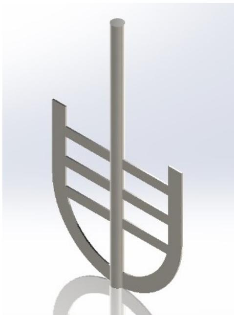
Figura 20. Diseño del Agitador Tipo Ancla, **Fuente:** Autores.
