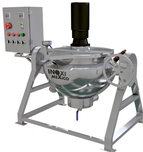
Figura 8. Marmita Semiesférica Basculante a Vapor/Eléctrica [17]
