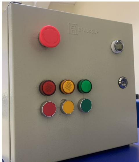
Figura 42. Gabinete Metálico - Pulsadores y Luces Piloto, **Fuente:** Autores.
