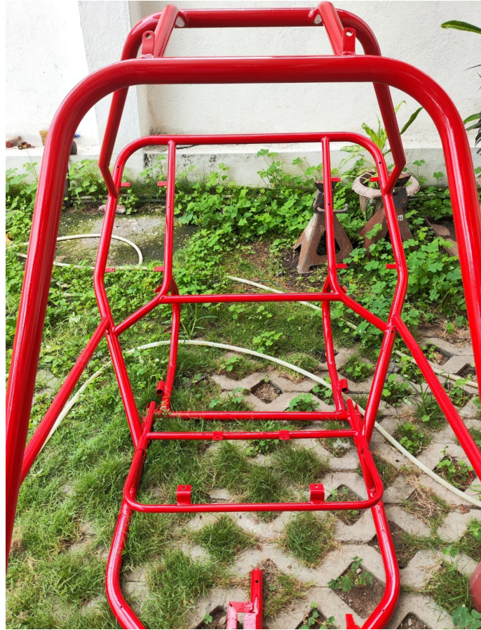
Figura 3. Estructura tubular, por J. Bohórquez y J. Calero
