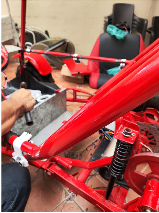
Figura 16. Diseño tubular del chasis del kart, por J. Bohórquez y J. Calero
