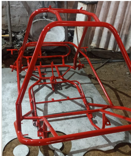
Figura 15. Diseño del chasis del kart, por J. Bohórquez y J. Calero
