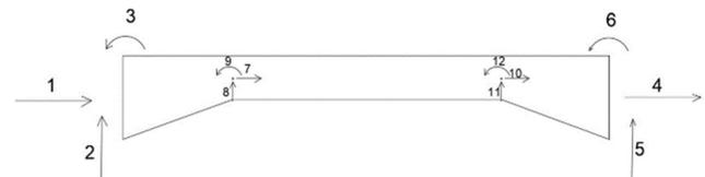
Esta numeración a diferencia de la indicada en el ítem 3.3.4., dependerá del número de tramos, pero siempre mantendrá los valores de 1, 2 y 3 para el extremo izquierdo y de 4, 5 y 6 para el derecho.
