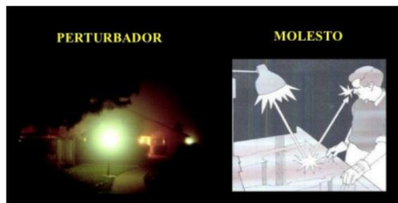
Figura 11: Deslumbramiento Perturbador y Molesto
