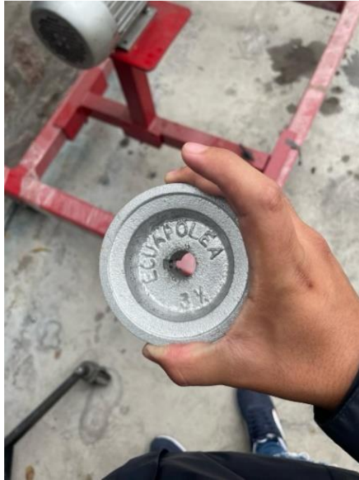
Figura 33. Polea motor eléctrico
