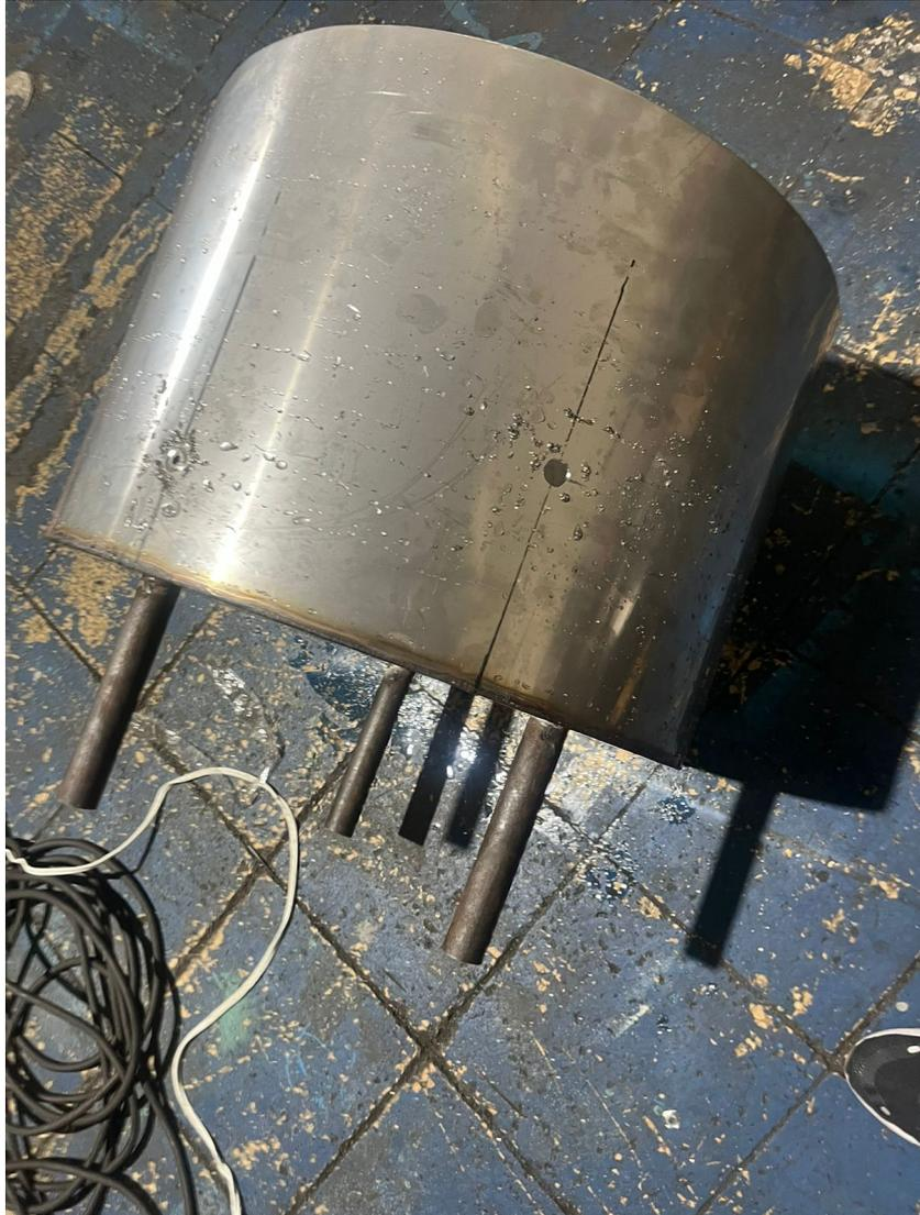
Figura 59. Tanque interno con perforaciones y soporte, por M. Granados y M. Vásquez.
