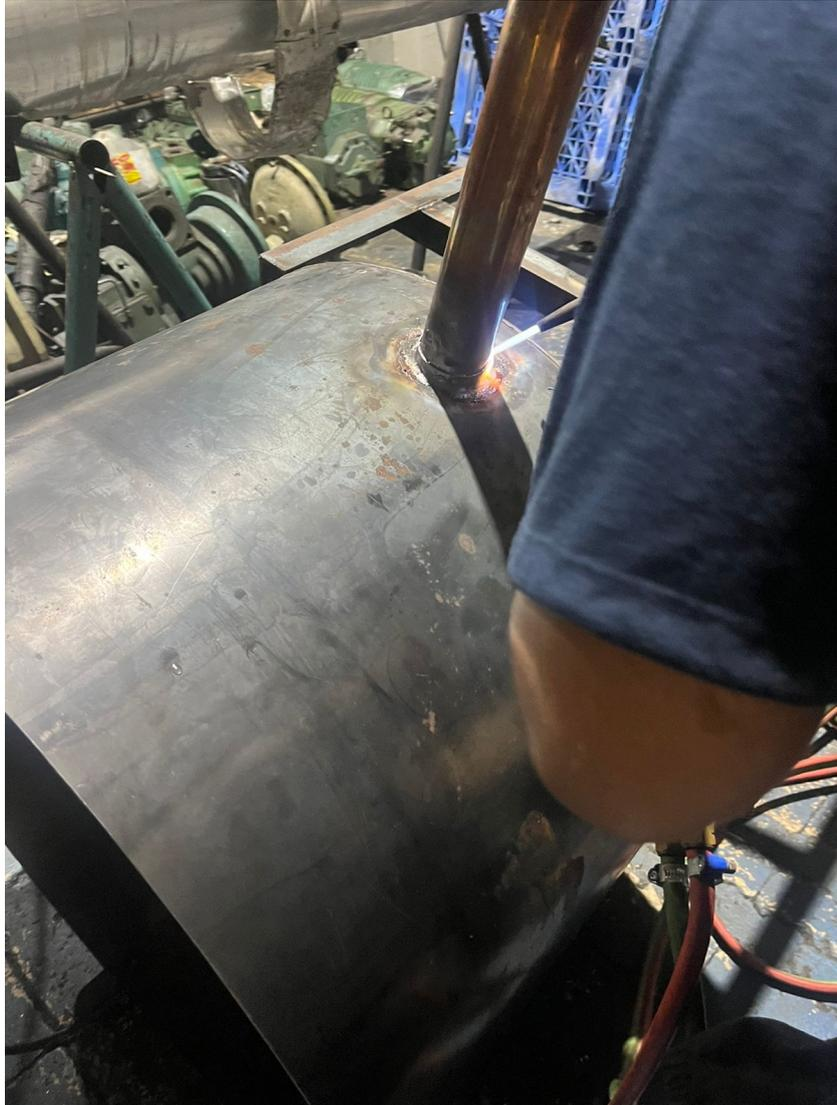
Figura 58. Soldadura del tubo de cobre que alimenta de aire caliente al tanque, por M. Granados y M. Vásquez.
