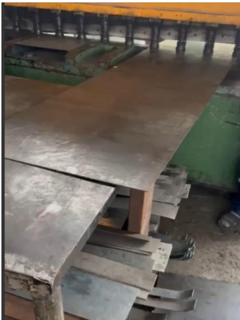
Figura 54. Corte en plancha de acero inoxidable de grado alimenticio, por M. Granados y M. Vásquez.
