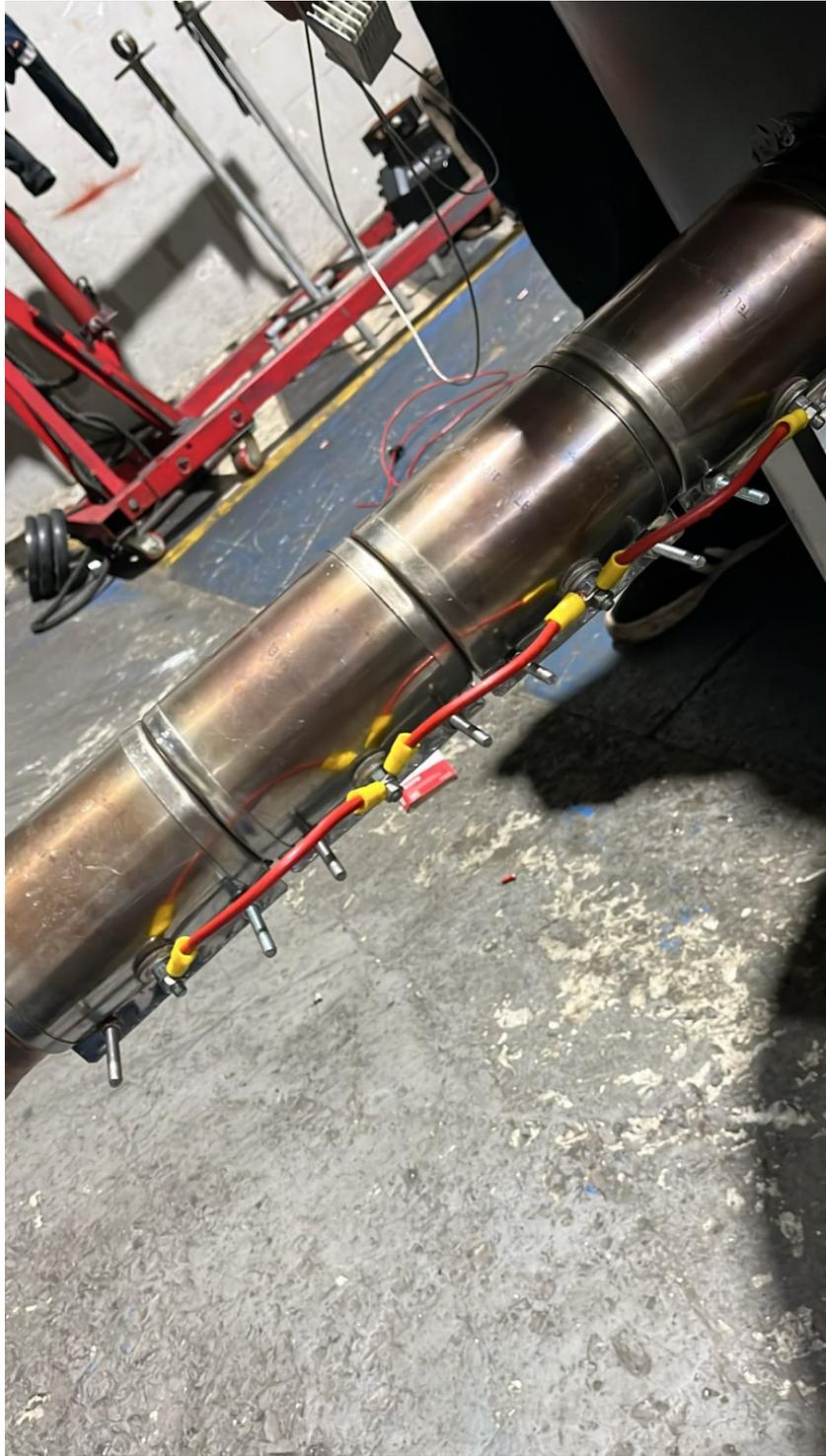
Figura 53. Conexiones de resistencias, por M. Granados y M. Vásquez.
