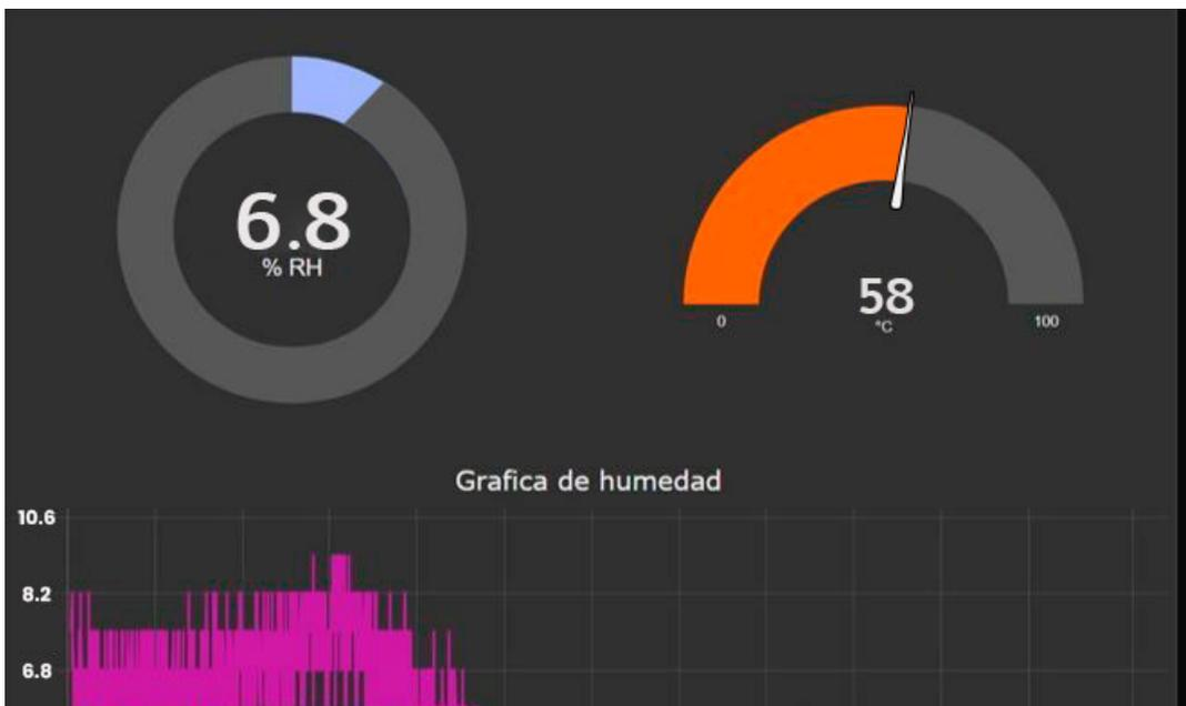
Figura 44. Monitoreo de variables al finalizar el proceso de secado a través de Node-red, por M. Granados y M. Vásquez.
