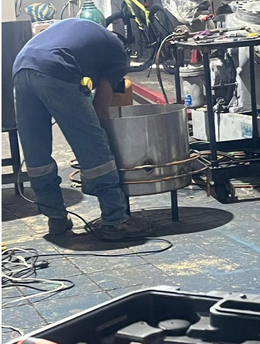
Figura 55. Soldadura del serpentín de cobre al tanque de acero inoxidable, por M. Granados y M. Vázquez.
