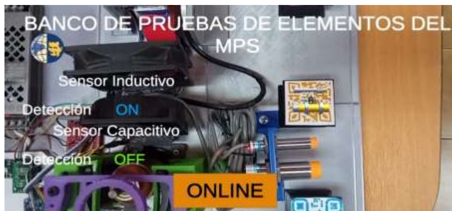
Fig.8. Pruebas de funcionamiento alterando las propiedades intrínsecas de sensores inductivos y capacitivos.
