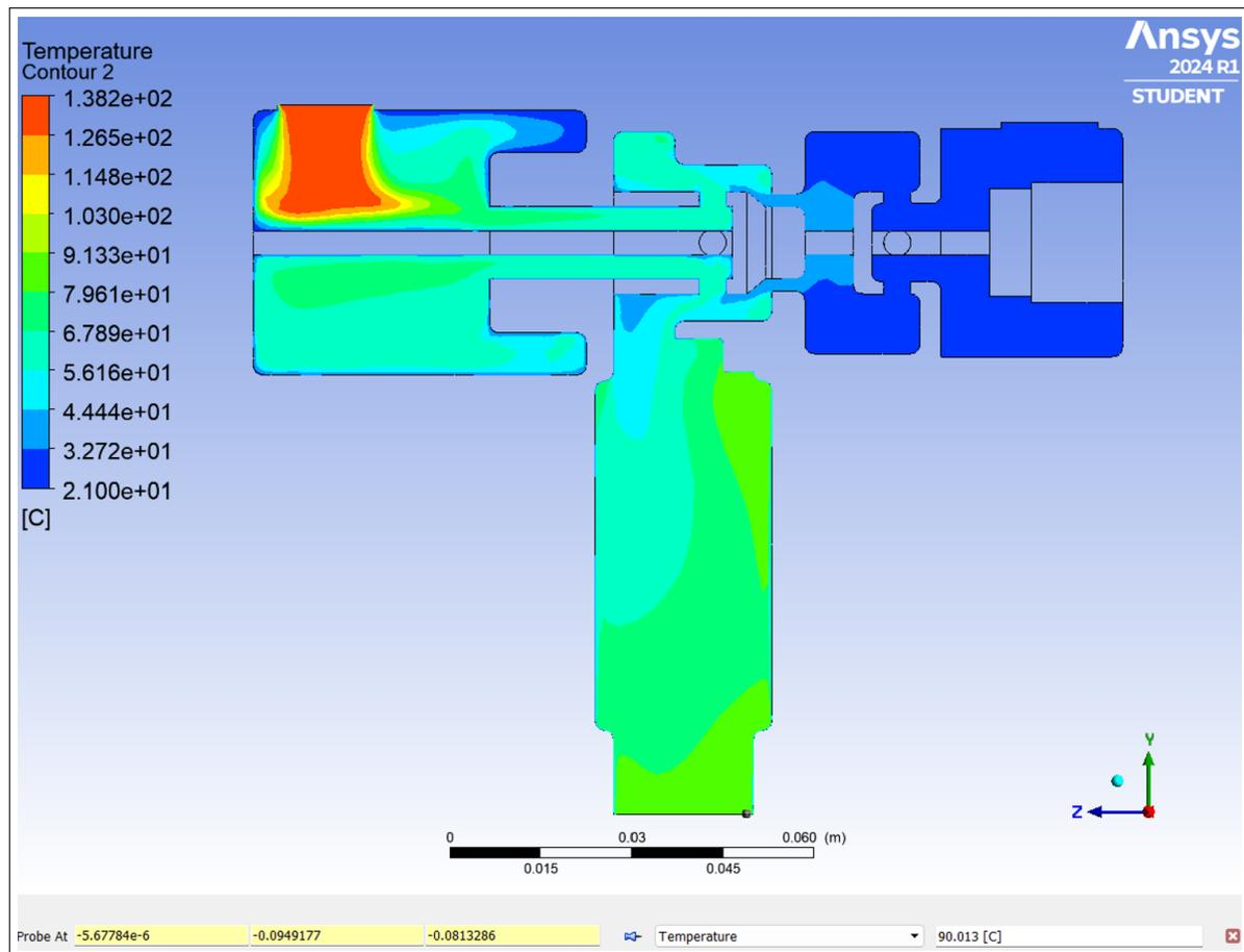
**Nota:** En la Figura se observa el comportamiento de la temperatura mediante el análisis computacional en la simulación escenario presiones bajas, llegando a un valor de temperatura en la salida de mezcla de 90.013 °C.
