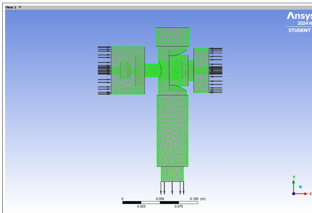
**Nota:** En la Figura se observa el modelado de la valvula incluido el pistón regulador de vapor, así mismo se aprecia a la derecha ingreso de agua, la entrada izquierda de vapor y en la parte inferior la salida de mezcla.
