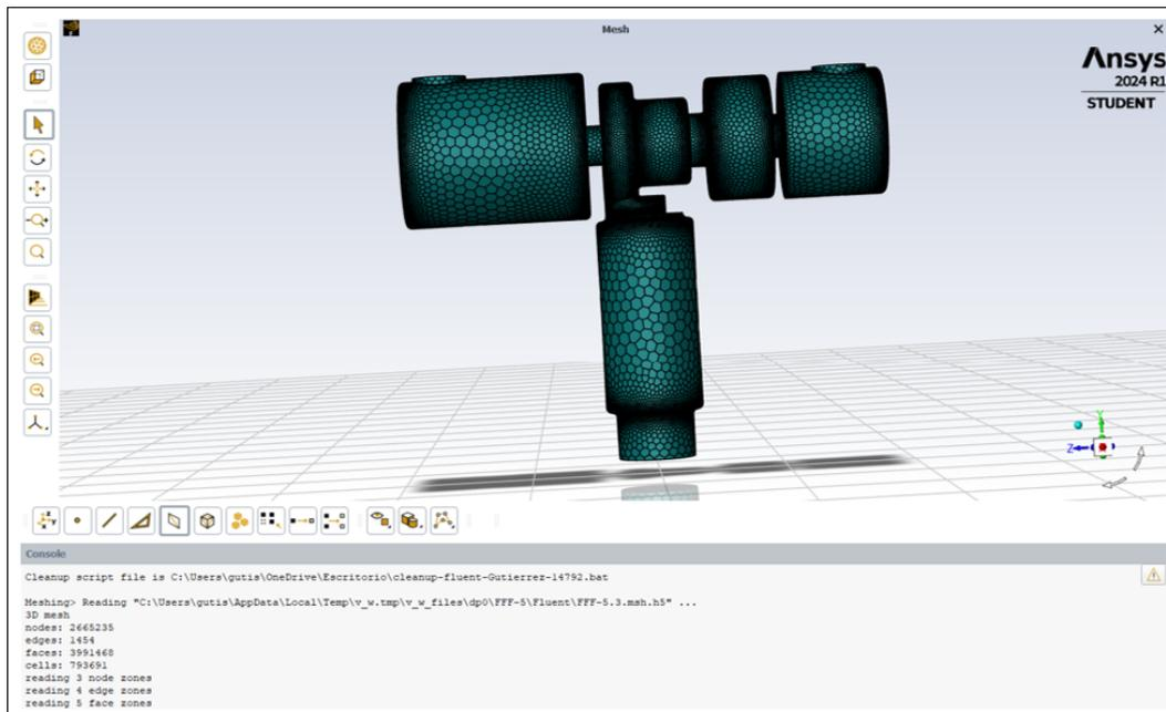
**Nota:** En la Figura se observa el mallado del elemento y su calidad.
