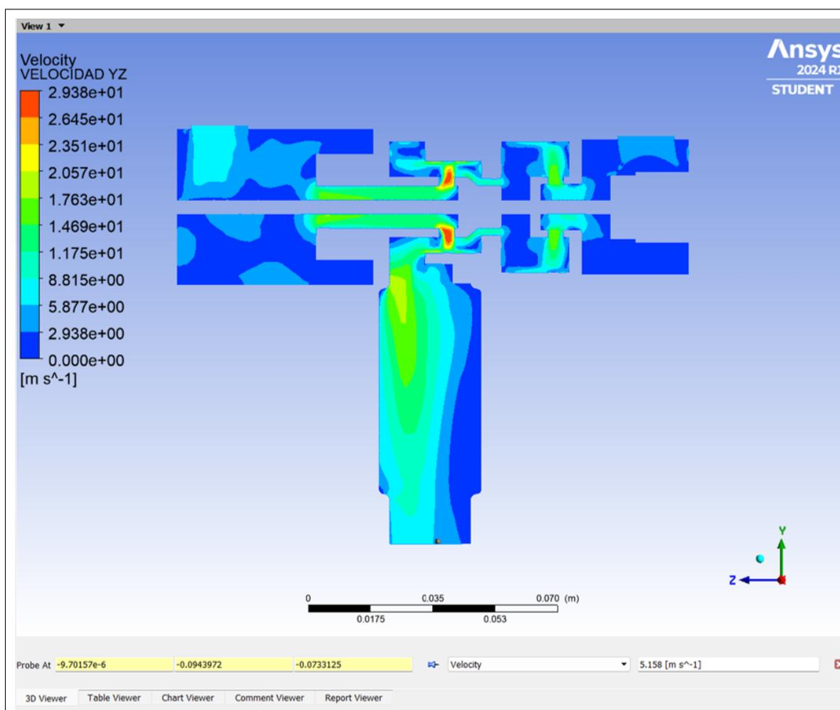
**Nota:** En la Figura se observa el comportamiento de la velocidad de la mezcla a la salida de la valvula mediante el análisis computacional.
