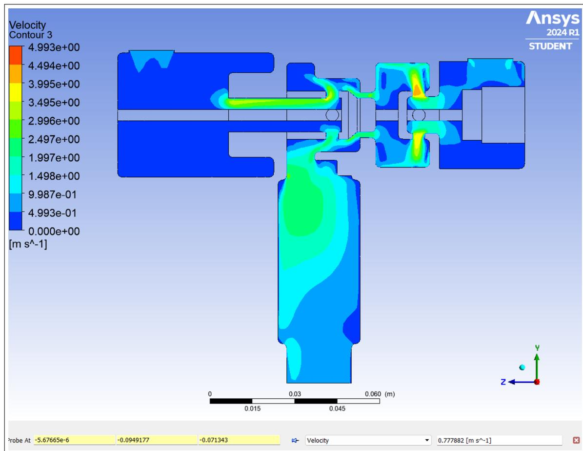
**Nota:** En la Figura se observa el comportamiento de la velocidad de la mezcla a la salida de la valvula mediante el análisis computacional para la simulación de escenario con presiones bajas el valor obtenido 0.7778 m/s.
