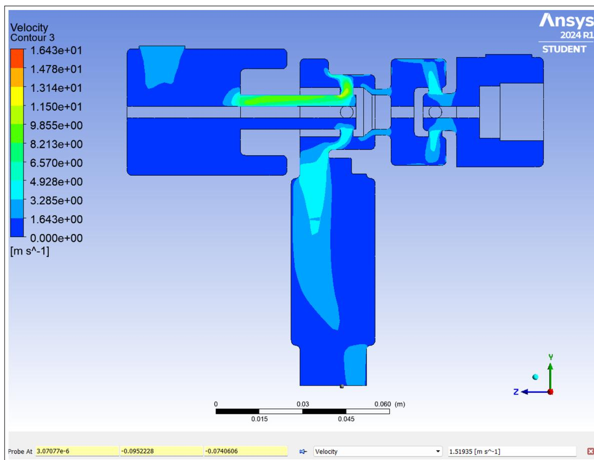
**Nota:** En la Figura se observa el comportamiento de la velocidad de la mezcla a la salida de la valvula mediante el análisis computacional para la simulación escenario presiones altas con un valor de 1.5193 m/s.
