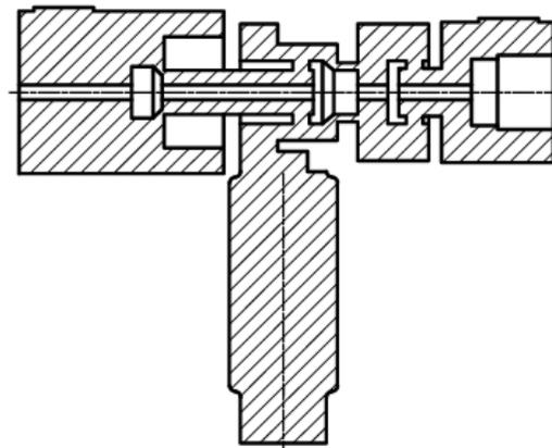
**Nota:** En las Figuras se observan el modelo físico para el análisis computacional, con las dos entradas de agua y vapor con la cámara de mezcla y la salida de agua caliente por la parte inferior.
