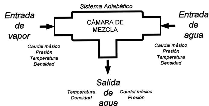
**Nota:** En la Figura se observa el esquema de flujos donde se especifica la forma y ubicación de entradas de agua-vapor, salida de mezcla y las condiciones del sistema de calentamiento de agua mediante vapor en la válvula mezcladora.
