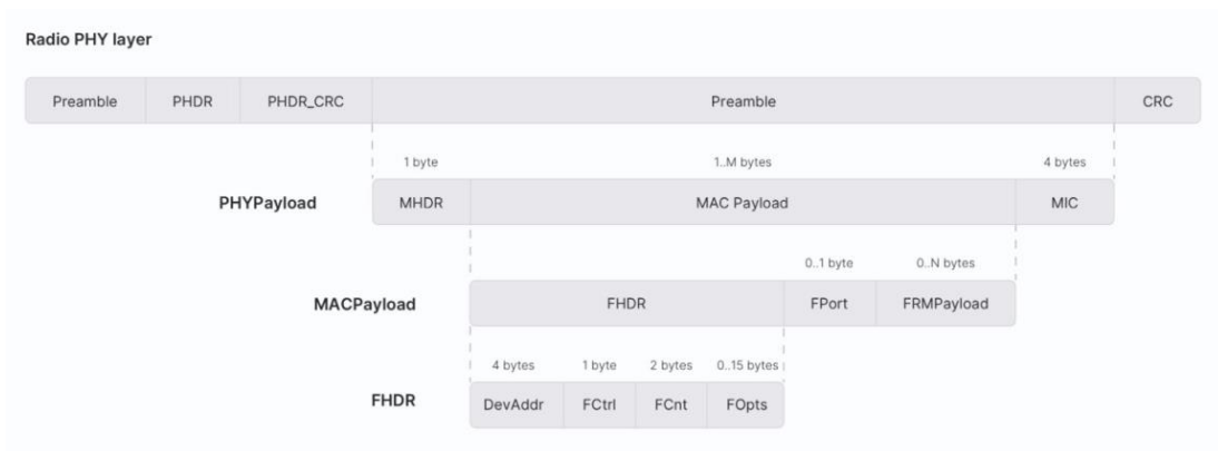
Figura 2.1 Estructura del paquete LoRa
