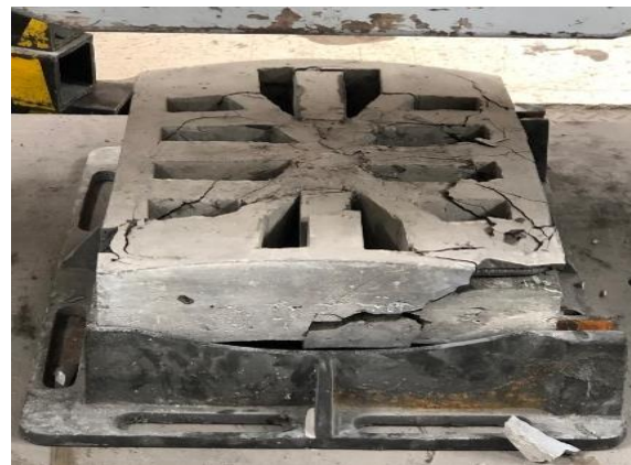
Figura 14. Rotura final de rejilla de sumidero vial.
