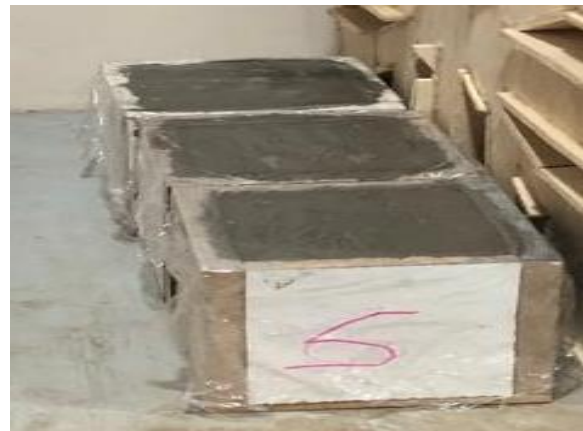
Figura 7. Encofrado de madera.
