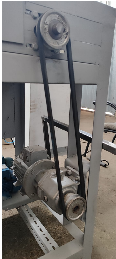
Figura 63. Transmisión de Banda de 1:1 Fuente: Realizado por Daniel Remache y Josh Sud
