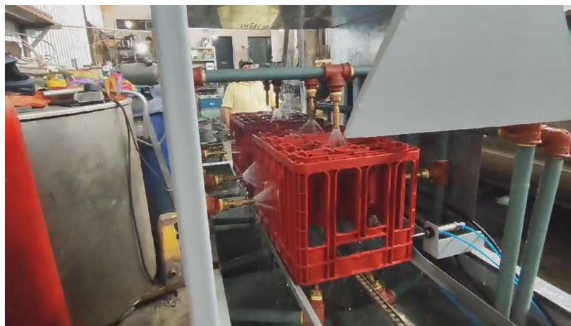
Figura 57. Fase 2 del sistema de lavado
