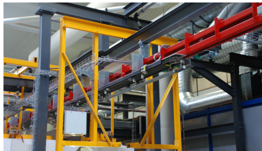
Figura 5. Sistema power & free (P&F).
