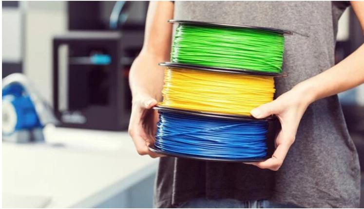
Figura 11. Rollos de PLA para impresión 3D [18].
