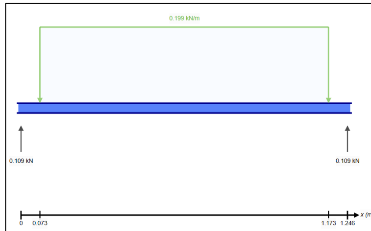
Figura 50: Diagrama de cuerpo libre para el eje tensor de banda plástica.
