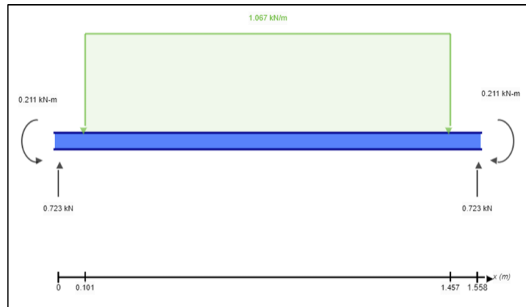
Figura 62: Diagrama de cuerpo libre para la sección 2-B.
