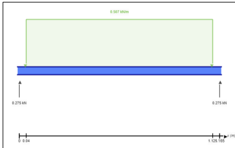
Figura 38: Diagrama de cuerpo libre para el tubo cuadrado de transmisión de la banda bi-apoyada con carga repartida.
