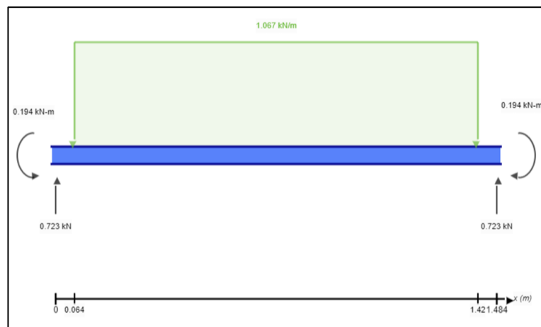
Figura 60: Diagrama de cuerpo libre para la sección 2-A.
