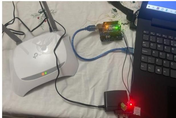
*Figura 7 Circuito de medición de corriente usando Arduino. Fuentes: Autores*
