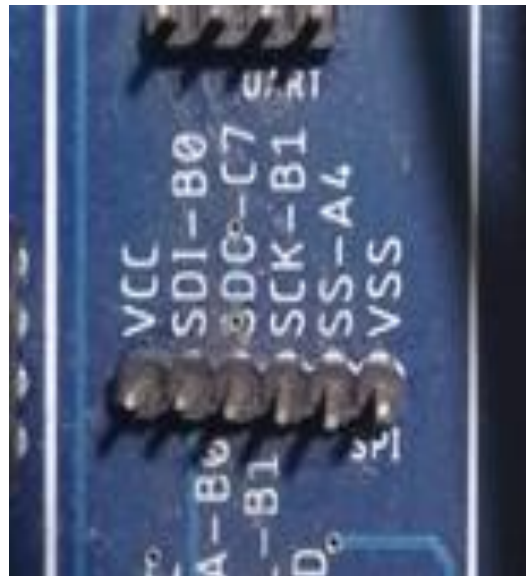
Figura 7. Conexiones del Bloque SPI al Módulo Max6675.
