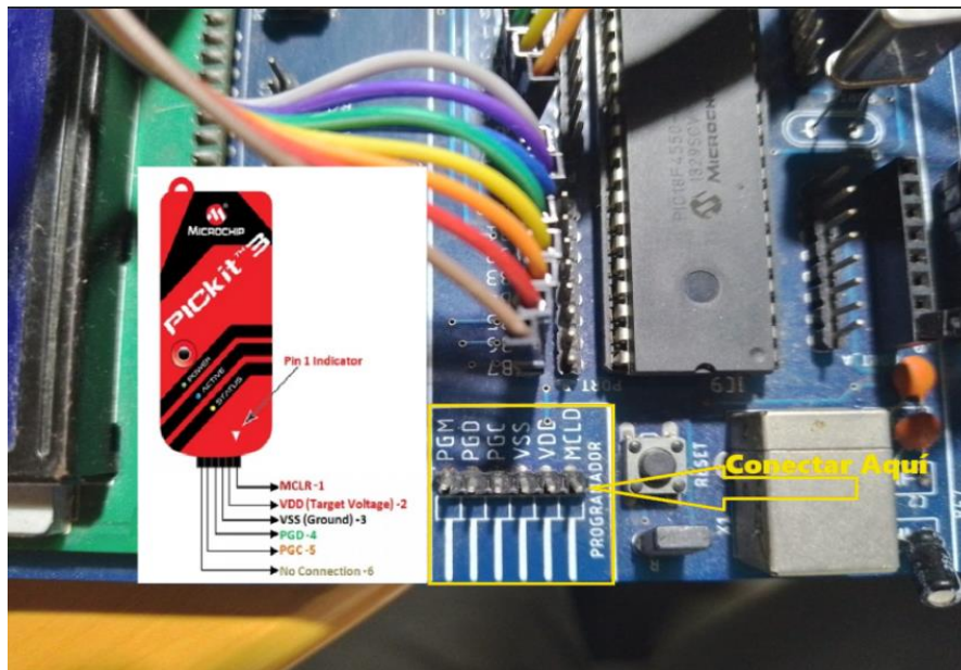
Figura 7. Conexión Pickit3 al Módulo.
