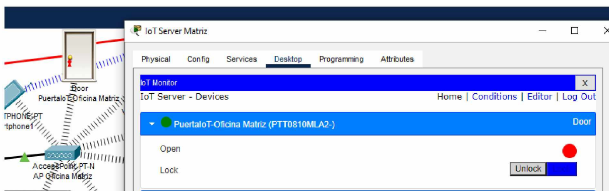
Figura 72 Pruebas de puerta IoT, bloqueo
