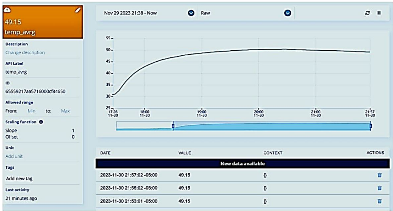
Figura 71. Gráfica de estabilización de temperatura en lazo abierto a 49.15 Celsius.
