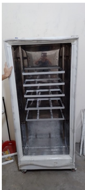
Figura 54. Implementación de bases para cubetas.
