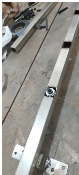
Figura 52. Rodamiento y ejes para las bandejas.
