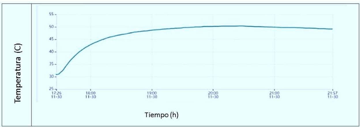
Figura 37. Curva de reacción de la temperatura de la incubadora a una entrada escalón de 115 voltios en la planta real.
