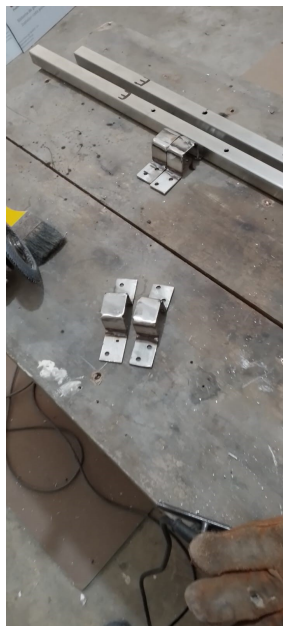
Figura 51. Base de platina para los tubos cuadrado.
