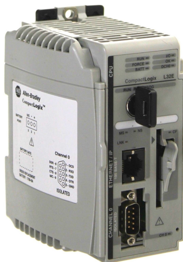
Figura 4: Controlador 1769-L32E. Fuente: [7]
