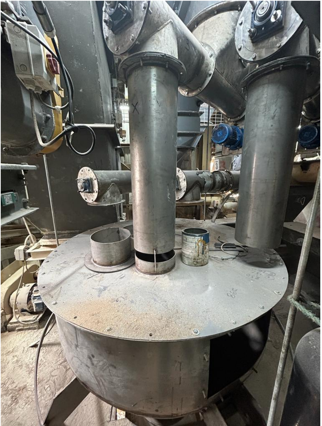
Figura 71: Descarga de tornillos en la balanza de medios. Fuente: Autoría Propia
