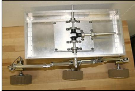
Figura 4: Adaptación del mecanismo Rocker-Bogie [6].
