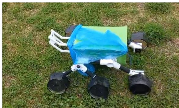
Figura 35: Robot desbrozador [35]
