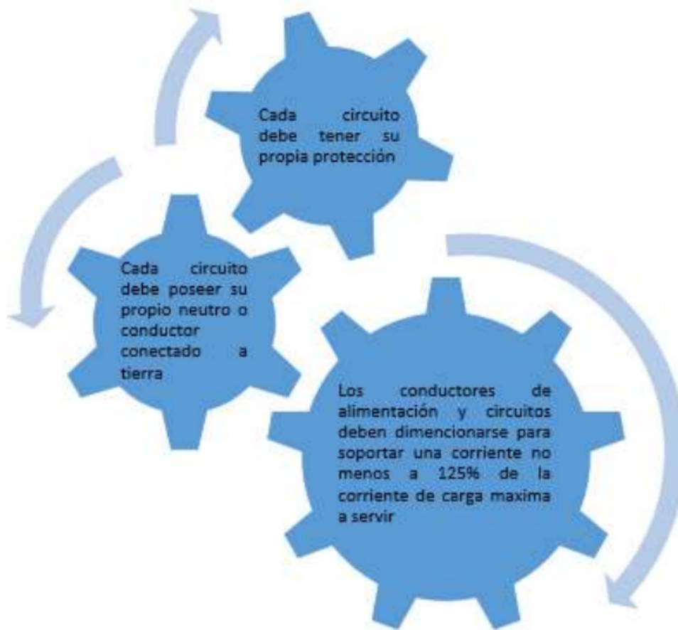
Figura 3.25: Características de cualquier circuito eléctrico.
