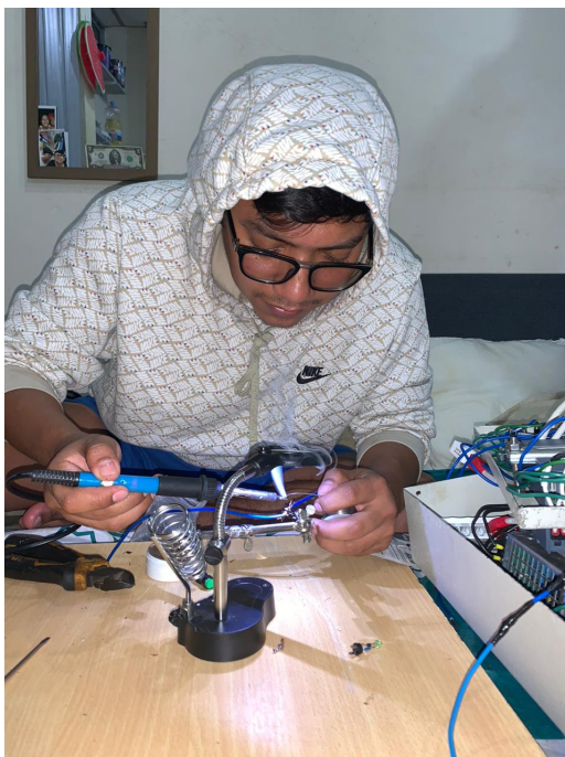
Figura 43: Cableado de puertos banana y pulsadores Fuente:Autores
