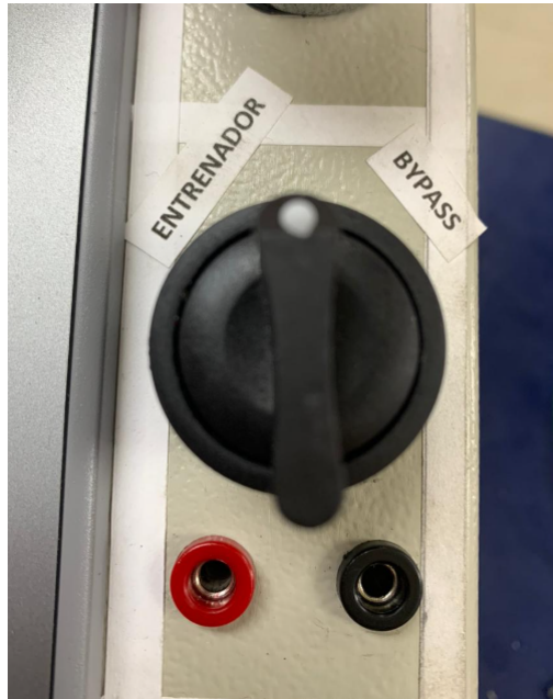
Figura 16: Selector del módulo Plc Fuente: Autores
