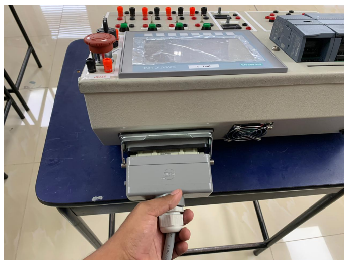
Figura 23: Conexión del clave de comunicación en el módulo entrenador Fuente: Autores
