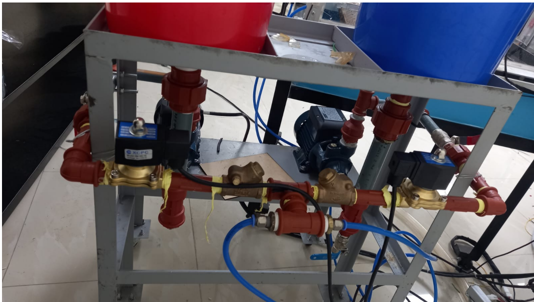
Figura 14: Sistema de flujo de agua Fuente: Autores
