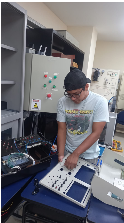
Figura 42: Montaje de entradas y salidas del equipo Fuente:Autores
