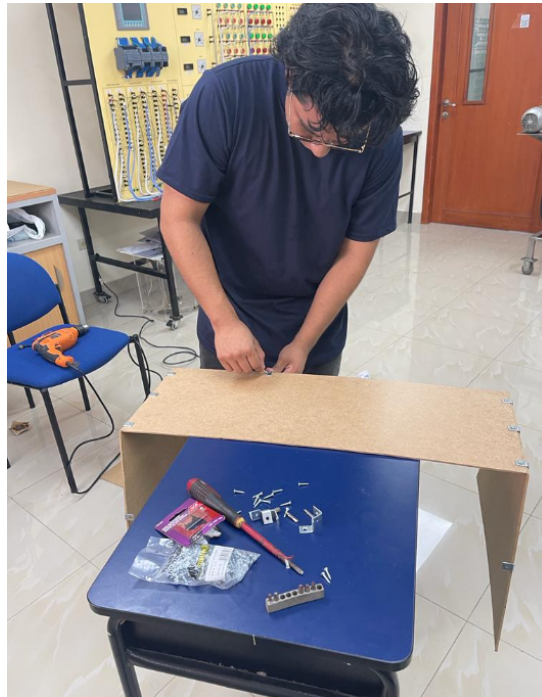
Figura 44: Montaje de piezas cortadas a láser del equipo Fuente:Autores
