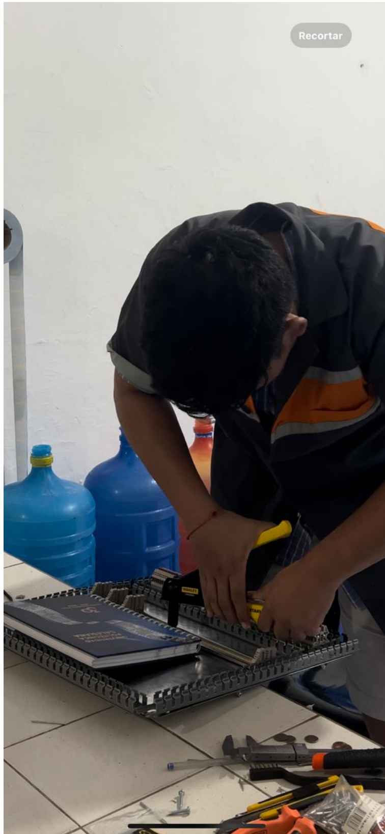
Figura 57. Instalación de riel en la placa de sujeción, por J. Solano y D. Ponce
