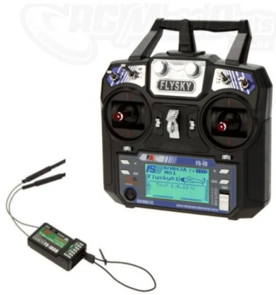
Figura 11. Control joystick con receptor. Fuente: [44]
