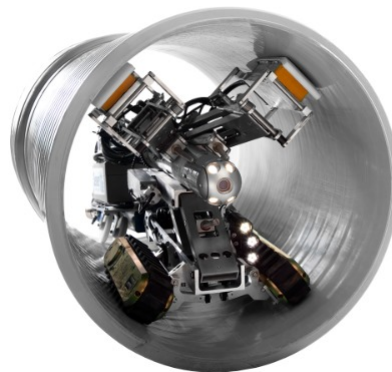
Figura 6. Robot explorador de tuberías.
