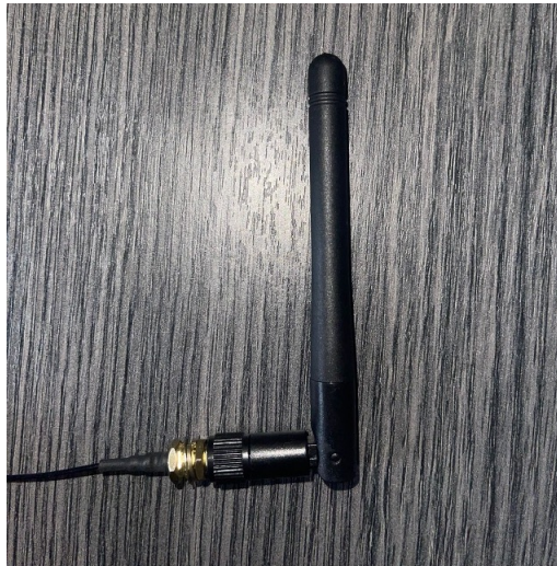
Figura 27. Antena para obtener mayor alcance de señal.
