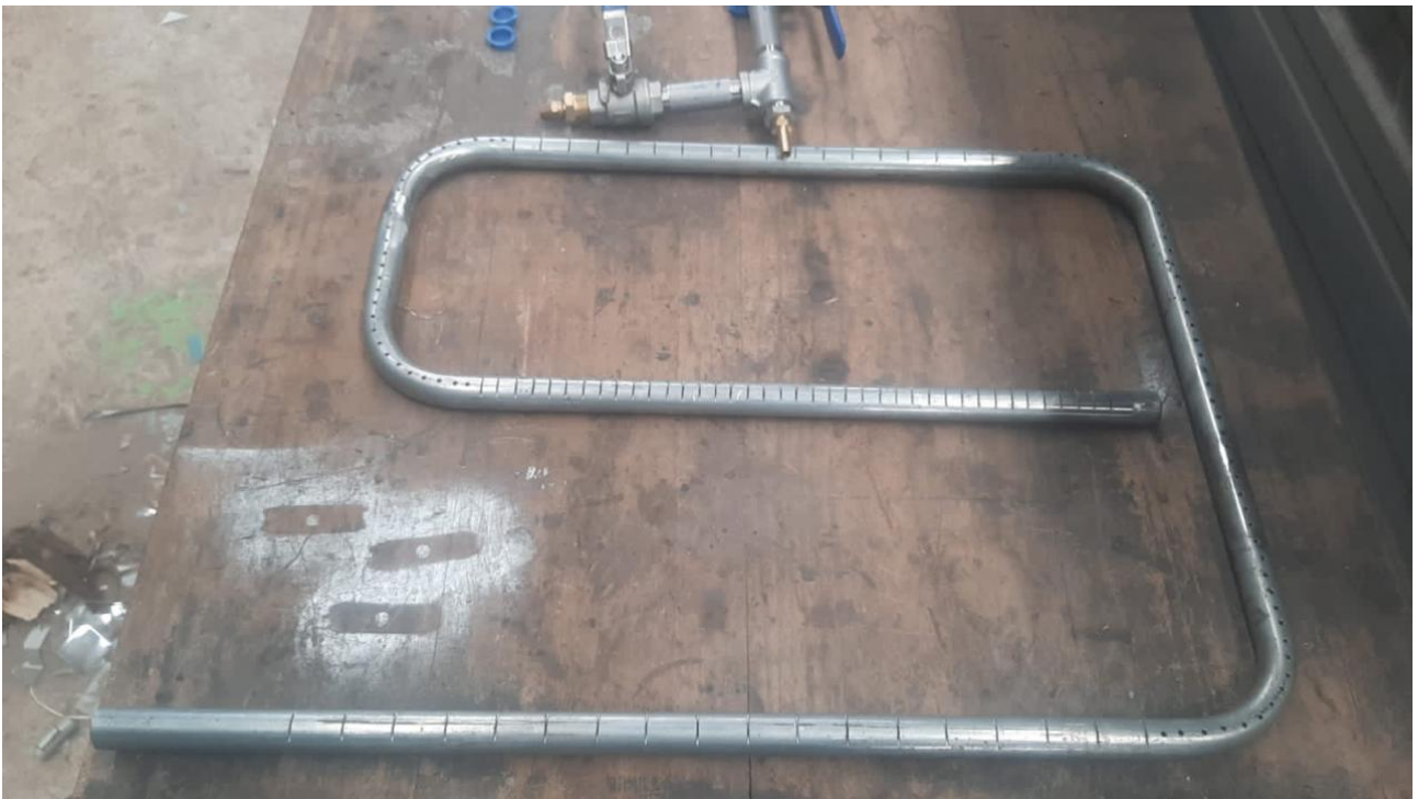
Figura 84. Quemador para el sistema automatizado, por A. Chafra y N. Alava
