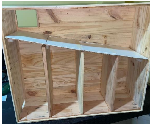
Figura 11.- Instalación de compuertas para clasificación de envases (Autores, 2024)
