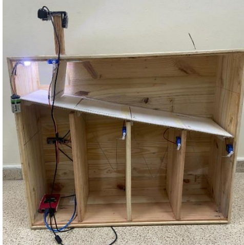
Figura 15.- Vista trasera del prototipo con las tres divisiones para envases de vidrio, plástico y metal. (Autores, 2024)
