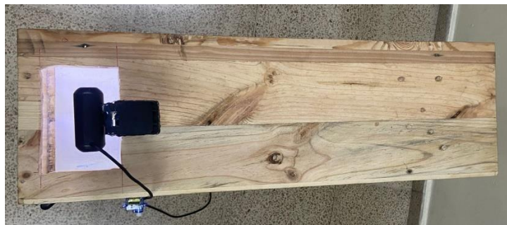
Figura 16.- Vista superior en donde se observa la cámara web para la identificación automática de los envases. (Autores, 2024)
