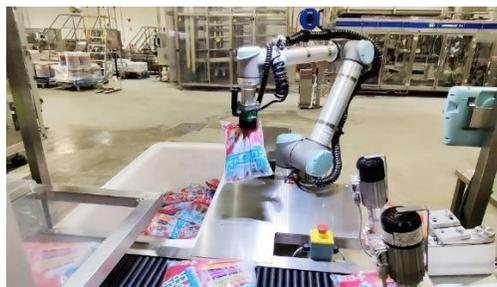
**Figura 5.** Robot pick and place separador de objetos [17].
