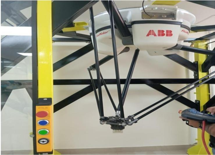
**Figura 33.** Calibración del robot con el Flexpendant.
