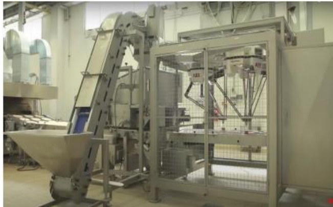
Figura 14. Uso del robot para masa Prodal [21].
