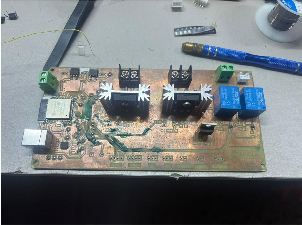
Figura 32 Soldadura de elementos electrónicos en pbc
