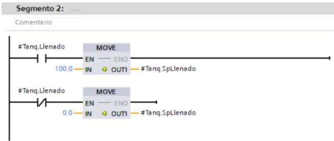
Figura 34: Se encarga de mover el valor de llenado a la salida.
