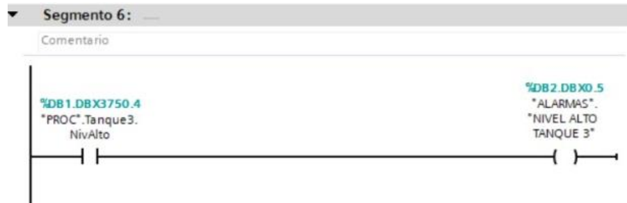
Figura 28: Segmento encargado de emitir la alarma de nivel alto en el tanque 3.
