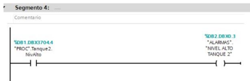
Figura 26: Segmento encargado de emitir la alarma de nivel alto en el tanque 2.
