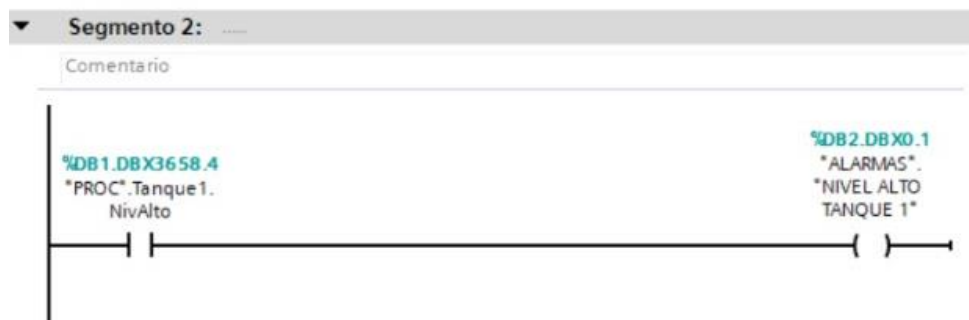
Figura 24: Segmento encargado de emitir la alarma de nivel alto en el tanque 1.
