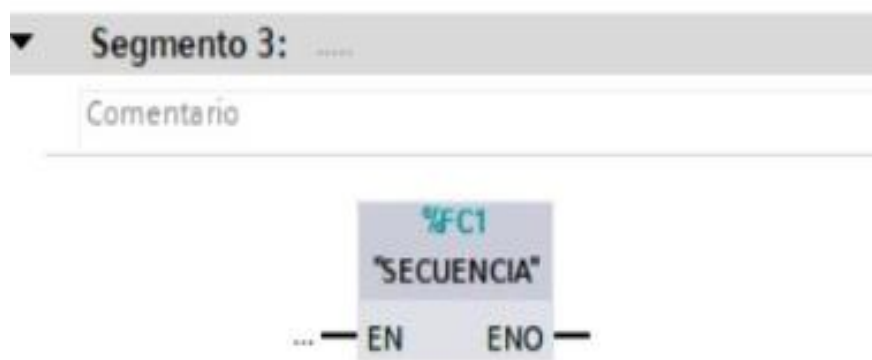
Figura 16: Bloque de Fc para realizar la secuencia de llenado de los tanques.
