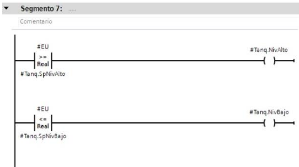
Figura 39: Comparador para permitir alarma de nivel alto y bajo.
