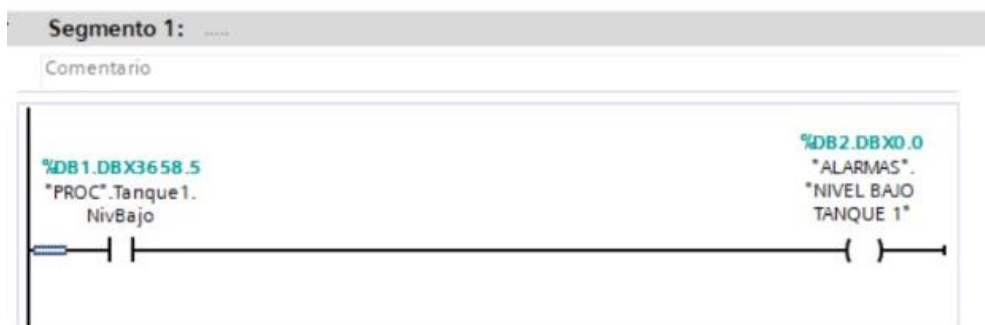
Figura 23: Segmento encargado de emitir la alarma de nivel bajo en el tanque 1.
