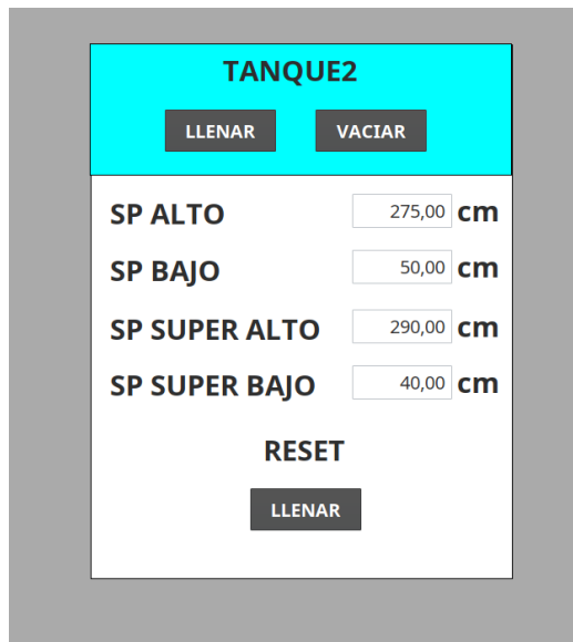
Figura 50: Indicador que realiza el vaciado de los tanques.
