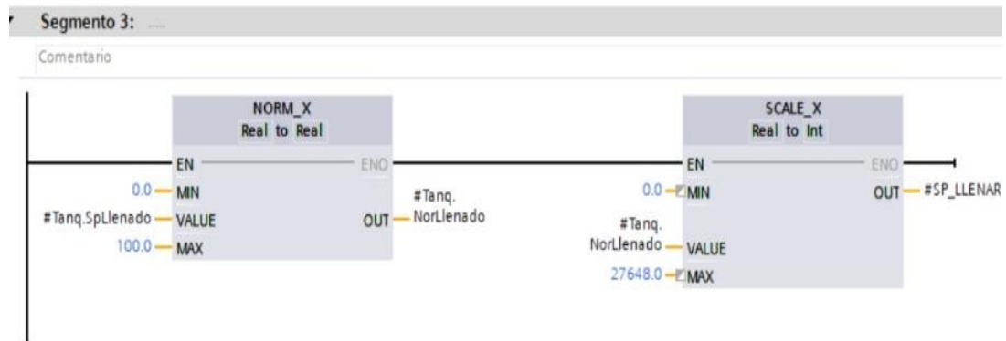
Figura 35: Es el escalado de la señal analógica correspondiente al llenado.
