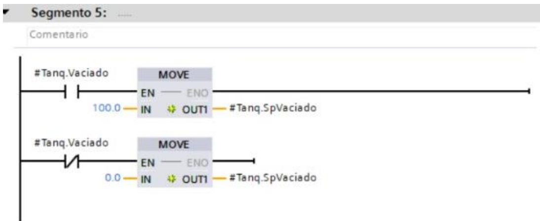
Figura 37: Se encarga de mover el valor de vaciado a la salida.
