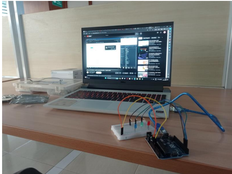
Pruebas de encendido de diodos led.
