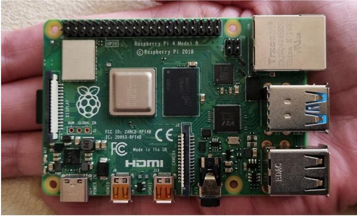
*Nota:* tarjeta Raspberry Pi IV usada para la programación de la identificación de la somnolencia en conductores.
