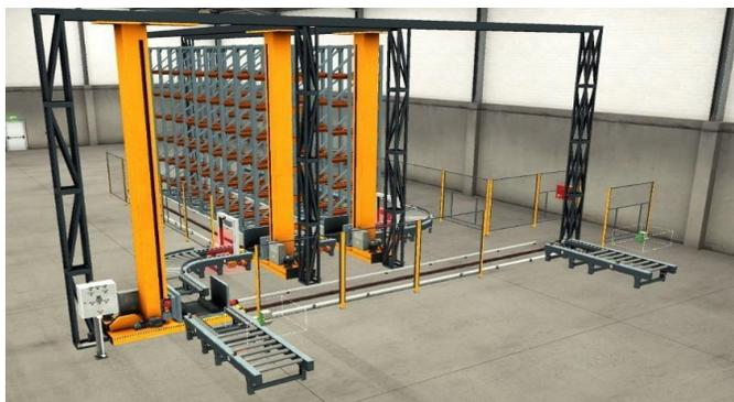
*Nota:* Se observa el ambiente virtual diseñado para un proceso de almacenamiento automático de lotes de planchas simulado en FACTORY I/O.
