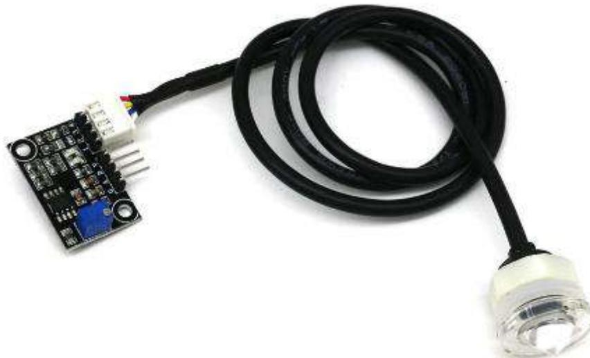
**Figura 15:.** Sensor de nivel de agua (Castillo Amado, 2023).
