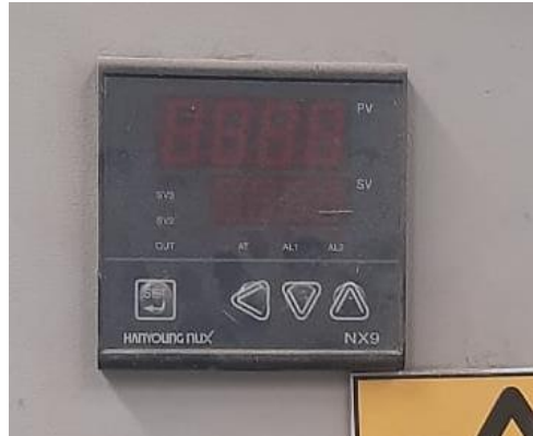
Figura 27. - Controlador de Temperatura modelo NX9-11 marca Hanyoung Nux.
