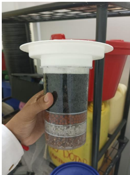
Ilustración 5 Filtro de cartucho con diferentes medios filtrantes
