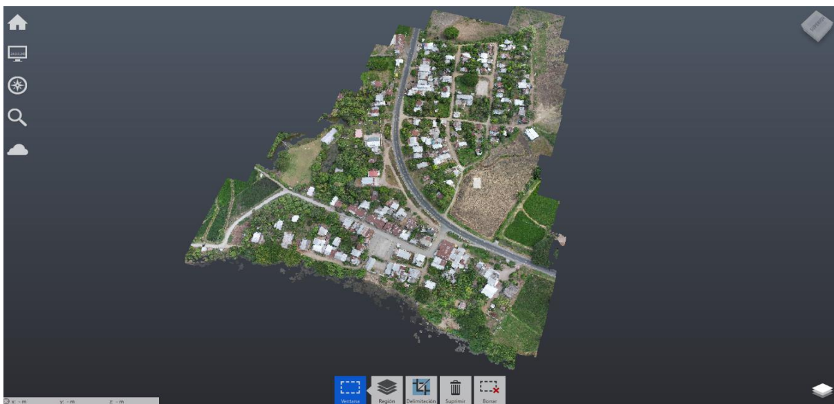
Ilustración 16 Nube de puntos obtenidos a través del software RECAP 3D.
