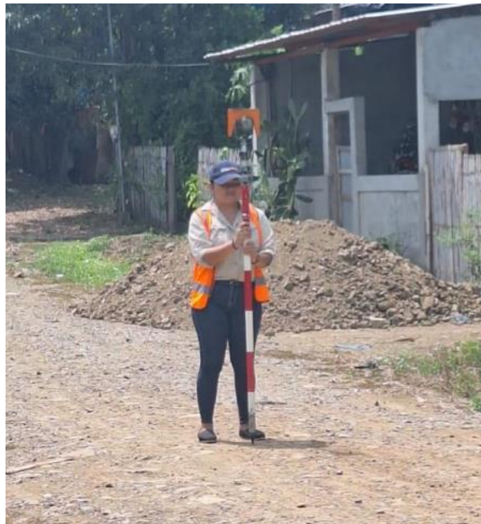
Imagen 14 Levantamiento topográfico con estación total y prisma en el recinto Yumes, Palestina.
