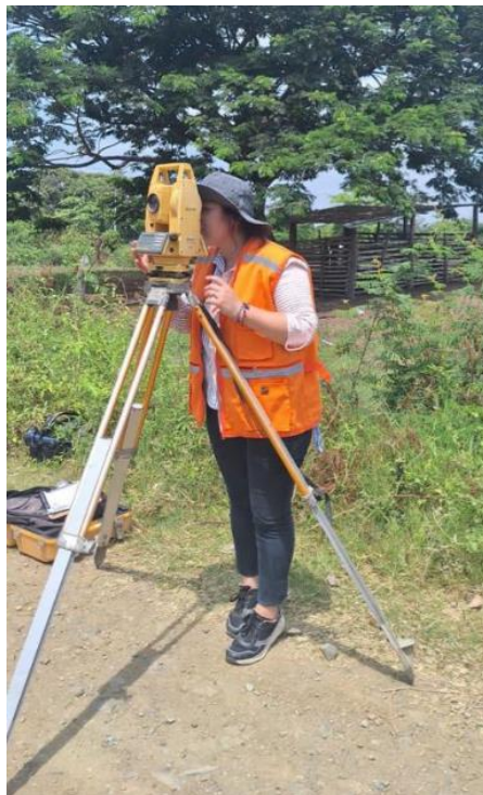
Imagen 16 Levantamiento topográfico con estación total y prisma en el recinto Yumes, Palestina.
