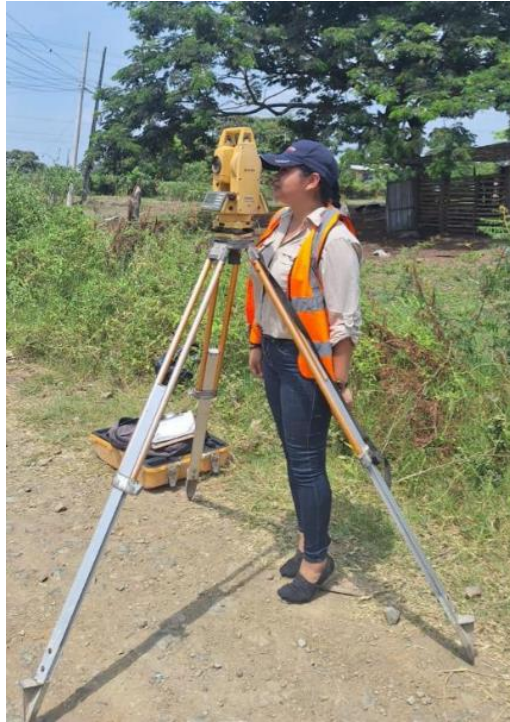
Imagen 15 Levantamiento topográfico con estación total y prisma en el recinto Yumes, Palestina.
