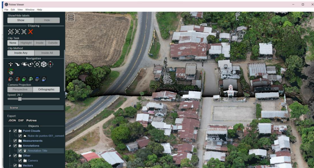
Ilustración 18 Modelo digital en 3D del terreno, procesado en el software POTREE VIEWER.
