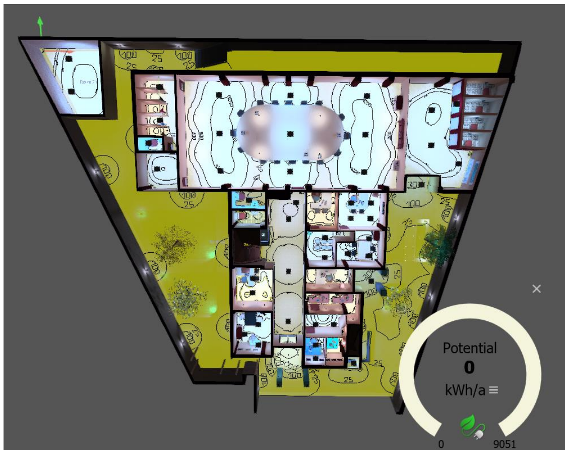
Figura 26: Simulación en Dialux planta baja de edificio Municipalidad de Sevilla de Oro.
