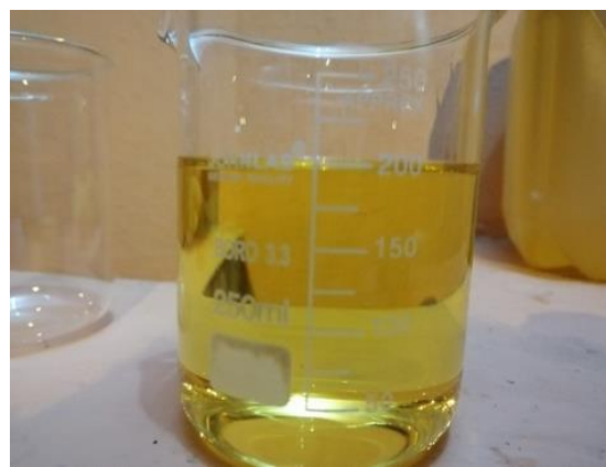
Ilustración 9. Se midió 200 ml de aceite dieléctrico con PCB.
