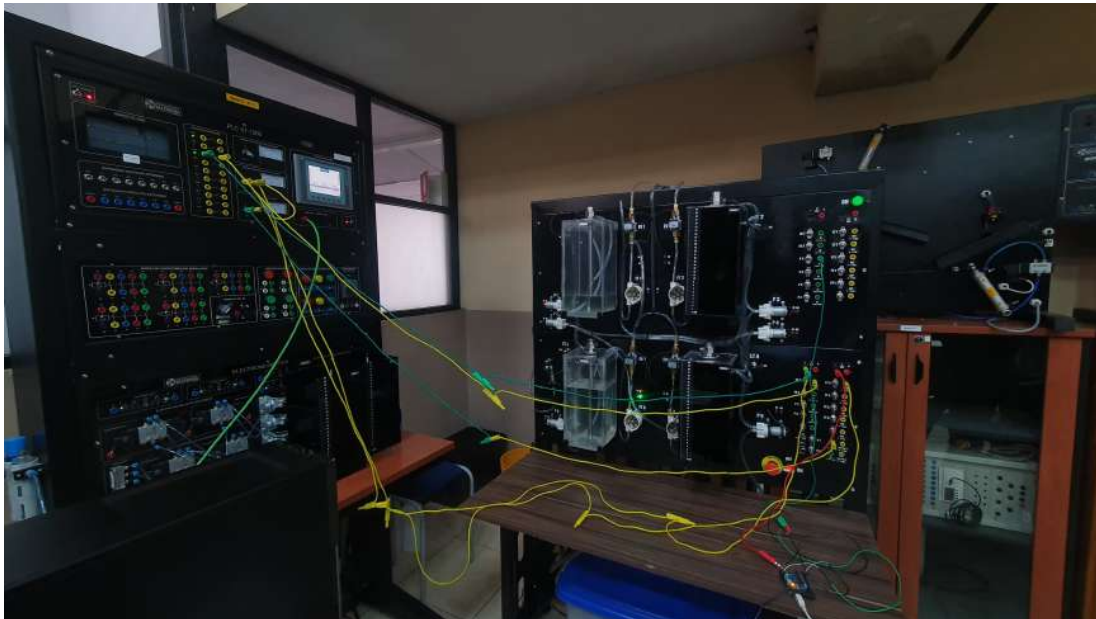
Figura 3.73: Comunicación del PLC con la planta. Fotografía autoría propia.
