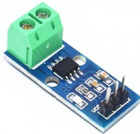
Figura 17: Sensor de corriente empleado
