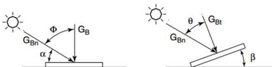
Figura 1: Radiación en una superficie inclinada.
