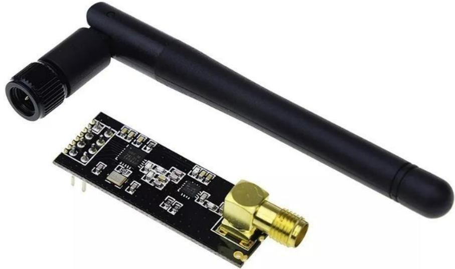
Figura 12: Modulo Rf Nrf24l01
