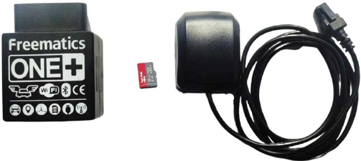
*Figura 5: Dispositivo Freematics ONE+, MicroSD y el módulo de geolocalización (GPS) modelo M8030*
