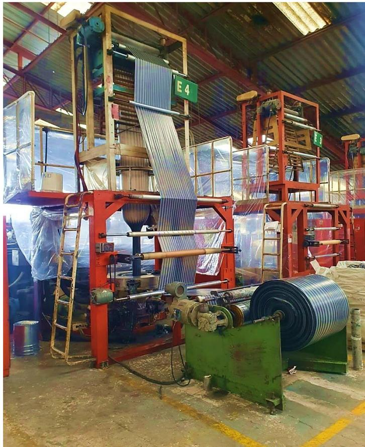
**Figura 3** Máquina de extrusión con película plástica.
