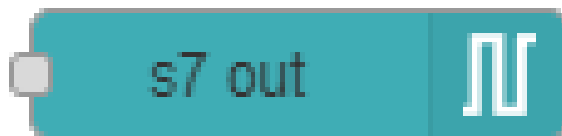
Figura 2.11: Nodo para escribir en el PLC
