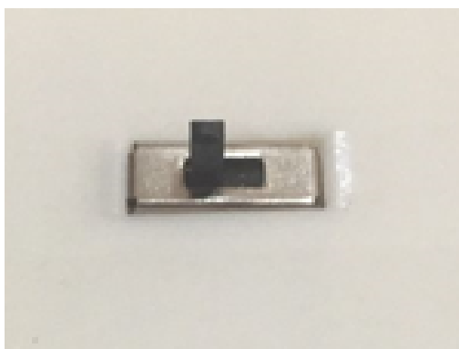
Figura A. 5 Switch de encendido del dispositivo mouse
