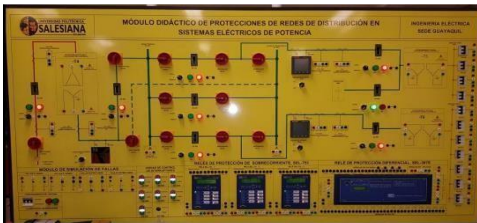
Ilustración 1, Módulo de Protecciones de Redes de Distribución
