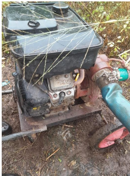
Imagen 5: Motor del Vanguard de 18 CV
