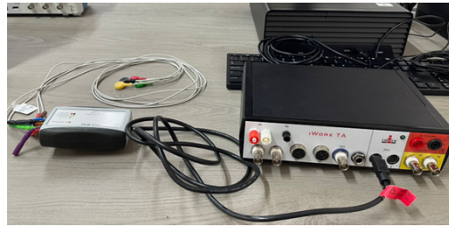
Figura 6: Grabador IX-TA-220 con conexión IWIRE-B3G
