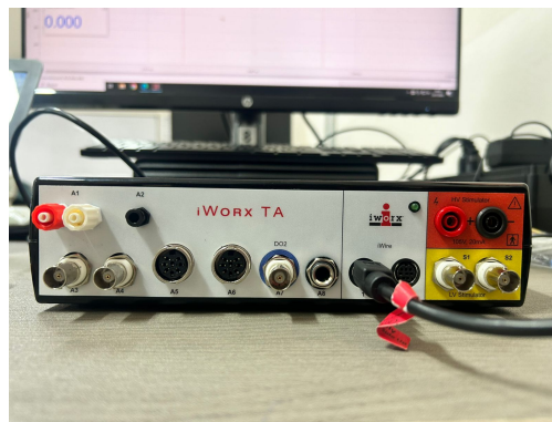
Figura 5: Grabador IX-TA-220 con sensores integrados.
