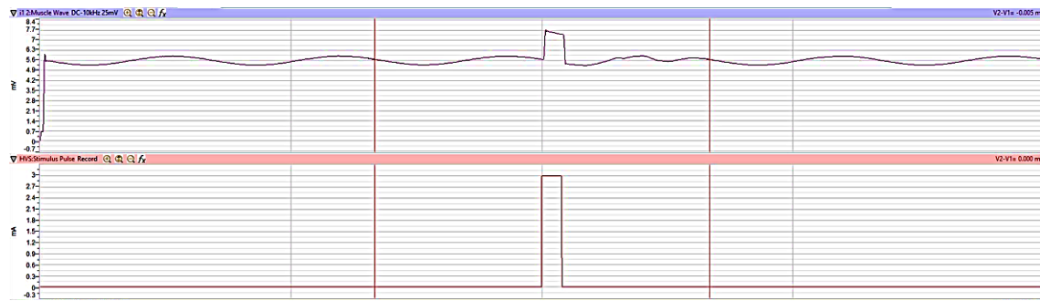
Figura 14: El resultado de la onda muestra un valor de estimulación de corriente de 3 miliamperio
