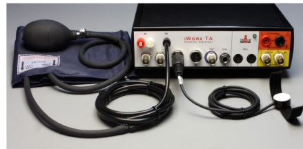
Figura 2: Grabador IX-TA-220 con conexión al transductor de presión.
