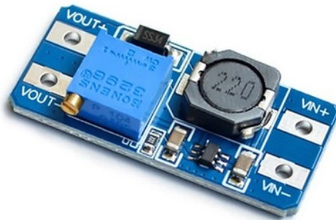
Figura 2.6: Módulo DC-DC Elevador Step Up regulable MT3608 2A [43]
