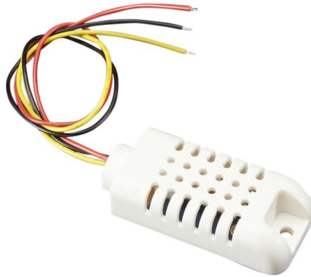
Figura 2.3: Sensor de Temperatura Ambiente (DHT21 AM2302) [37]
