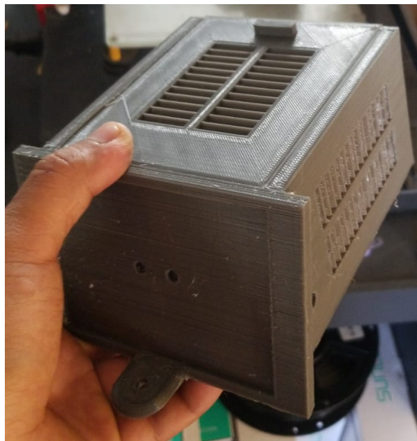
Figura 3.64: Impresión en 3D de las estructuras [Fuente: Autor]
