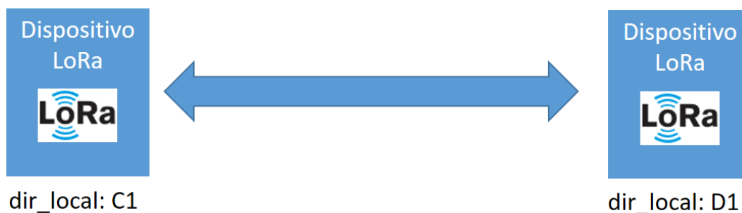
Figura 1.7: Conexión punto a punto [25]
