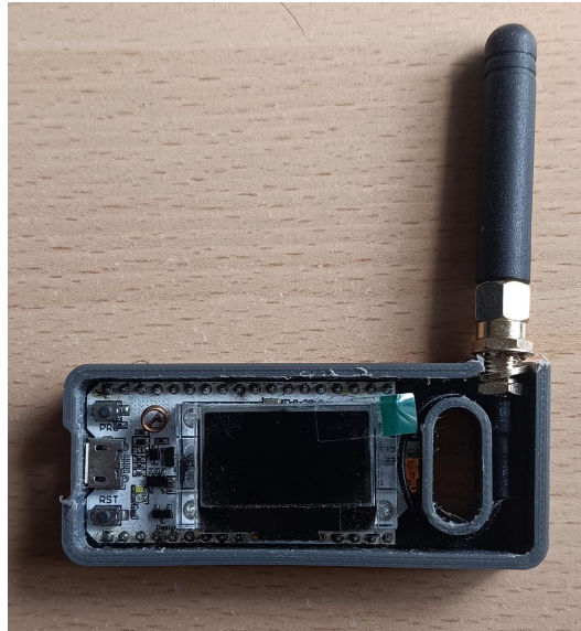
Figura 3.67: Visualización interna del dispositivo receptor [Fuente: Autor]
