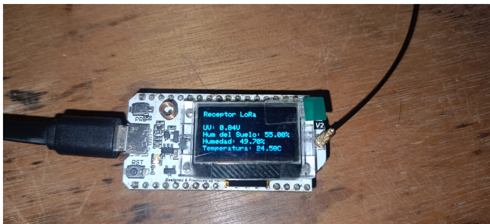
Figura 3.26: Modulo receptor [Fuente: Autor]
