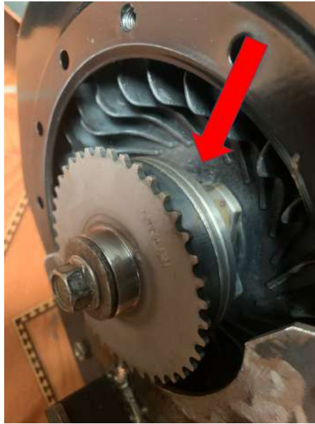
Figura 1.21: Bendix ajustado al cigüeñal del generador Fuente: Autores.
