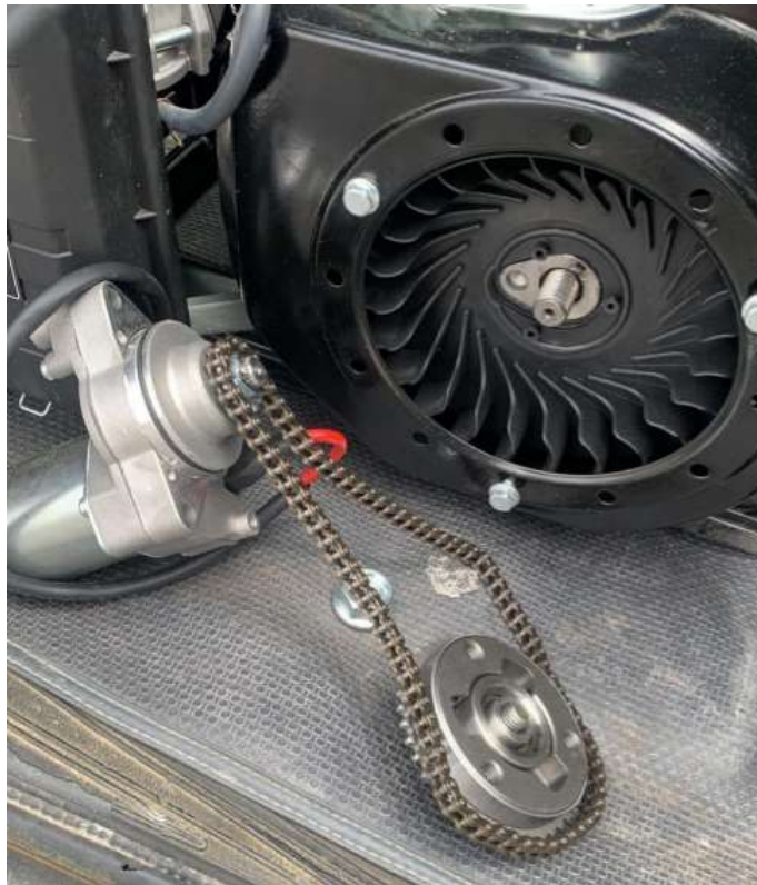
Figura A.1: Montaje de sistema de anclaje, cadena y motor de arranque en el cigueñal.
