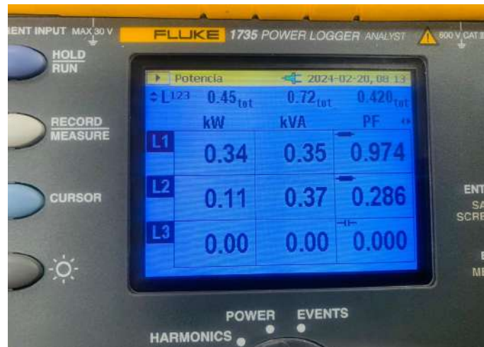
Figura C.6: Medición de potencia KVA
