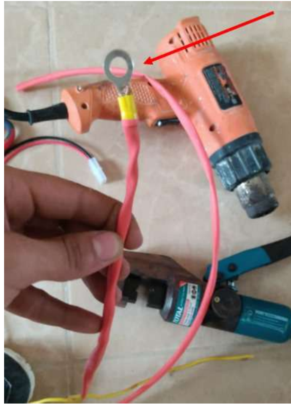
Figura 1.24: Ponchado de cables eléctricos Fuente: Autores.
