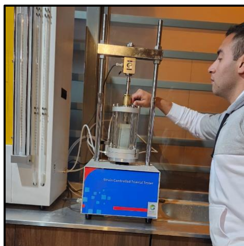
Ilustración 51: Especimen 5, Fuerza aplicada de 100 KPa (Fuente; Laboratorios GEO & GEO CIA. Ltda.)
