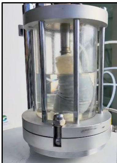
Ilustración 52: Espécimen 6, Fuerza aplicada de 200 KPa (Fuente; Laboratorios GEO & GEO CIA. Ltda.)
