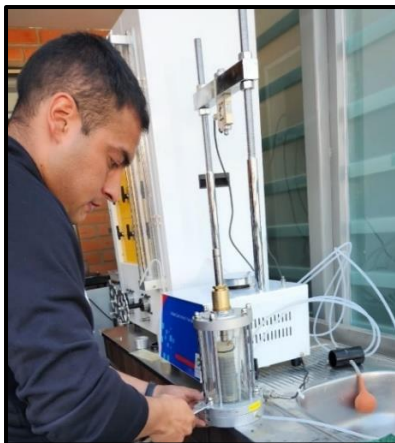
Ilustración 47: Espécimen 1, Fuerza aplicada de 50 KPa (Fuente; Laboratorios GEO & GEO CIA. Ltda.)
