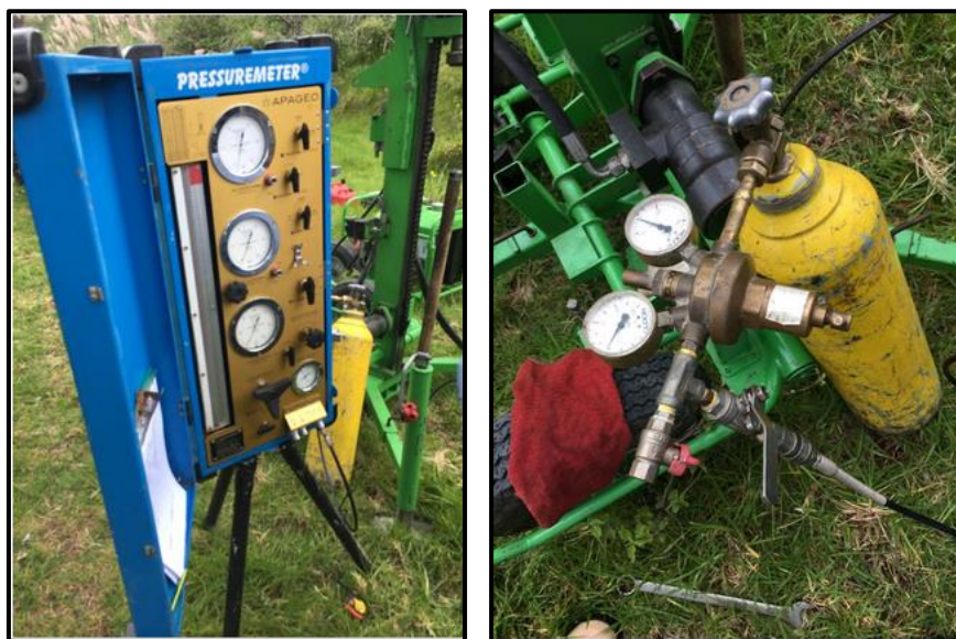
Ilustración 28 Presiómetro y Tanque de Nitrógeno- fuente (GEO & GEO CIA. Ltda.)
